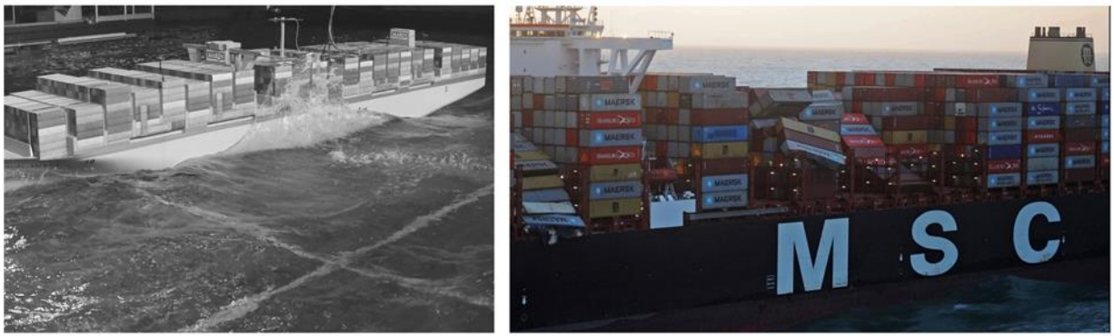
Containerverlies MSC ZOE boven de Wadden onderzocht in Offshore Basin.
