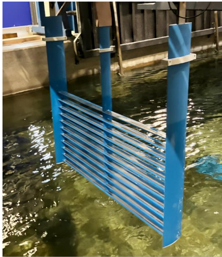
Elektrolyse grid om luchtbelletjes aan te maken.
