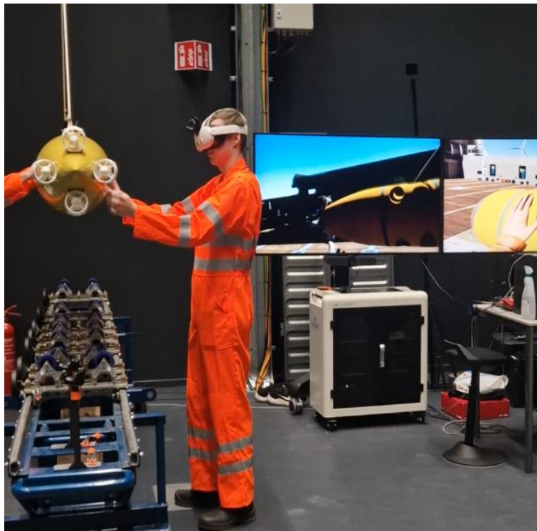
VR simulatie waarin de operators een lading aan een kabelrobot moeten vastpakken.
